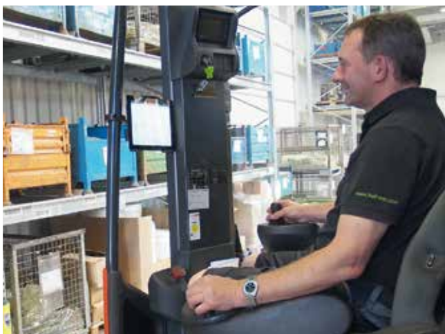
3 Die Vernetzung von Produktion und Logistik bringt Klarheit in die Lager- und Materialverwaltung. Per iPad werden die benötigten Positionen angezeigt (Bild: Hanser)
