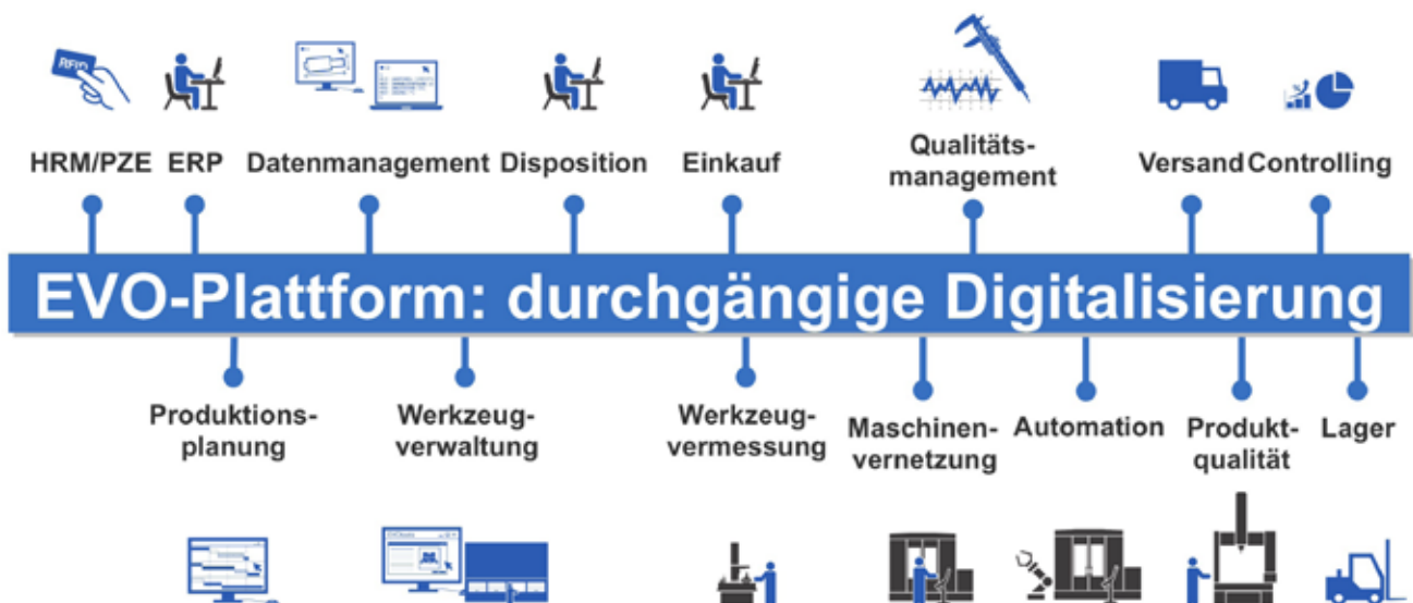
Die Plattform für ein umfassendes Fabrik-Betriebssystem setzt sich aus einzelnen Softwarebausteinen zusammen, die auch einzeln eingesetzt werden können
